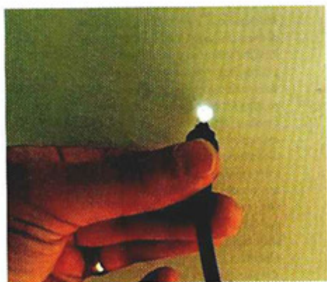
Figura 3. Las fibras ópticas se han convertido en el medio más empleado para conducir información mediante la luz visible y la radiación infrarroja.
