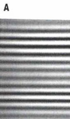
Figura 6. En (A) un interferograma con luz blanca obtenido mediante objetivos de microscopio tipo Mireau mostrados en (B).
